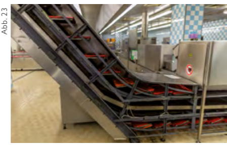
Abb. 23 Die Verkleidung am „Aufwärts“-Teil des roten Bandes blieb in der Regel für schnelle technische Eingriffe offen.
